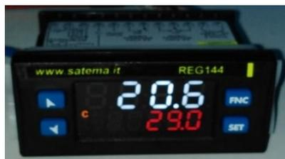
Altre importanti funzioni presenti sono: funzione di Loop-Break Alarm, Raggiungimento Set Point a velocità controllata, controllo a due spezzate con tempo di mantenimento intermedio, funzione di Soft-Start, funzione di protezione compressore per controllo a zona neutra, protezione parametri su vari livelli.
